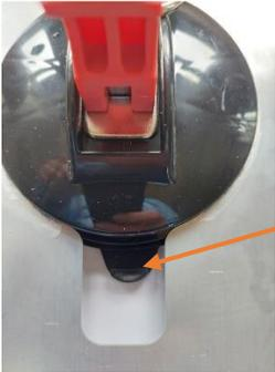
Die Saugnapf-Entlüftungen müssen sich in der mittigen Position der Blechaussparung befinden.
